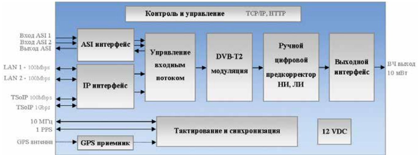
Рисунок 1. Структурная схема модулятора TTV-MDT2
