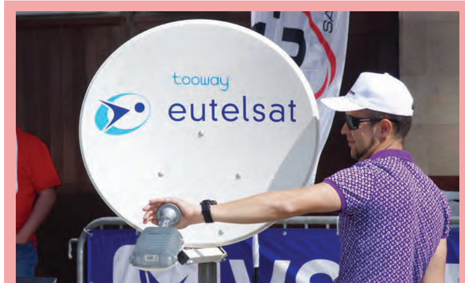
VSAT-Чемпионат 2016. Самая простая и грубая проверка настройки: при таком положении руки сигнал должен пропадать.
