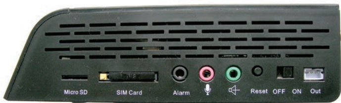
Правая стенка UMK-587 с разъемами интерфейсов Блока безопасности
