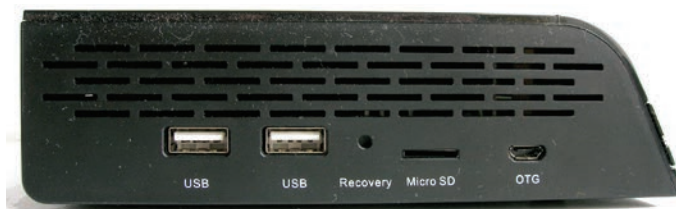
Левая стенка UMK-587 с разъемами интерфейсов мультимедийной платформы
