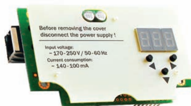
М-729 — плата мониторинга, обеспечивающая дистанционное управление и настройку оптического приемника MOB-729
