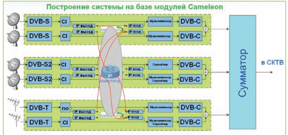
Рис. 1. Пример структурной схемы построения системы на базе модулей Chameleon с IP-коммутиацией.
