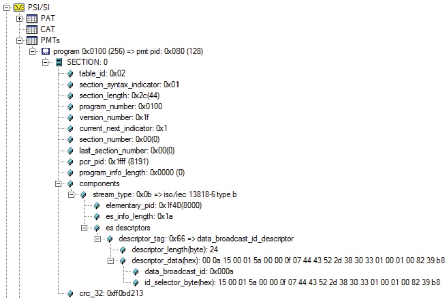
Рис. 2. Пример структуры PMT таблицы для потока данных обновления ПО
