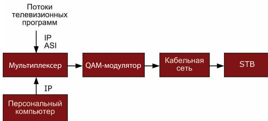
Рис. 1. Структурная схема организации обновления ПО по эфиру
