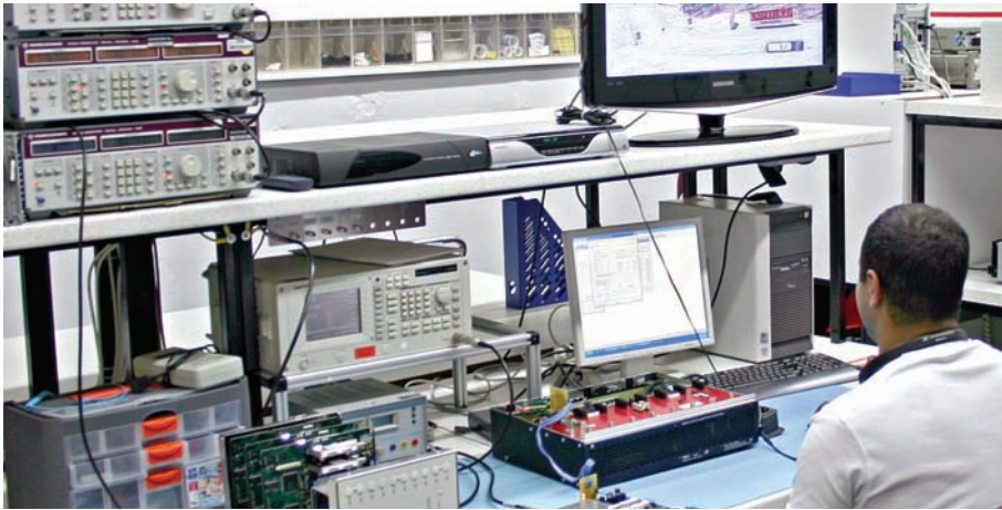
Полуавтоматический конечный контроль оборудования для головных станций
