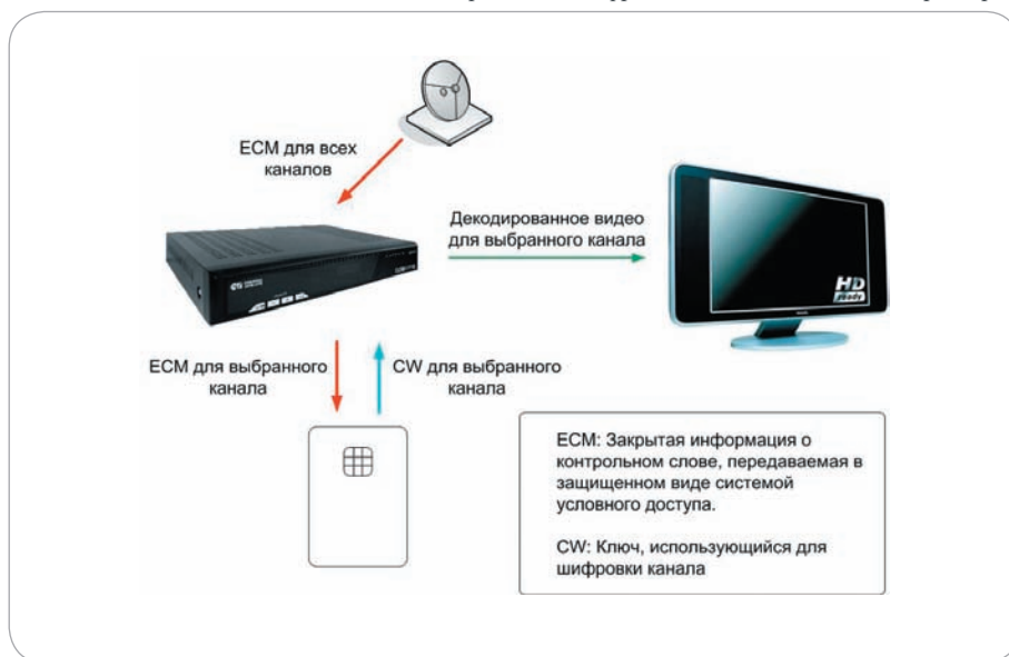
Рис. 1. Принцип дешифрации потока с помощью смарт-карты
